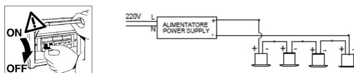
Per i collegamenti utilizzare un cavo con sezione minima 0.5mm<sup>2</sup>, non superare i 30m di cavo al secondario.
